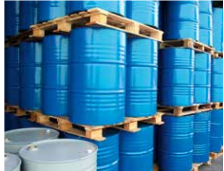
Bild 11-2: Palettenstapel mit stabilem Ladegut
