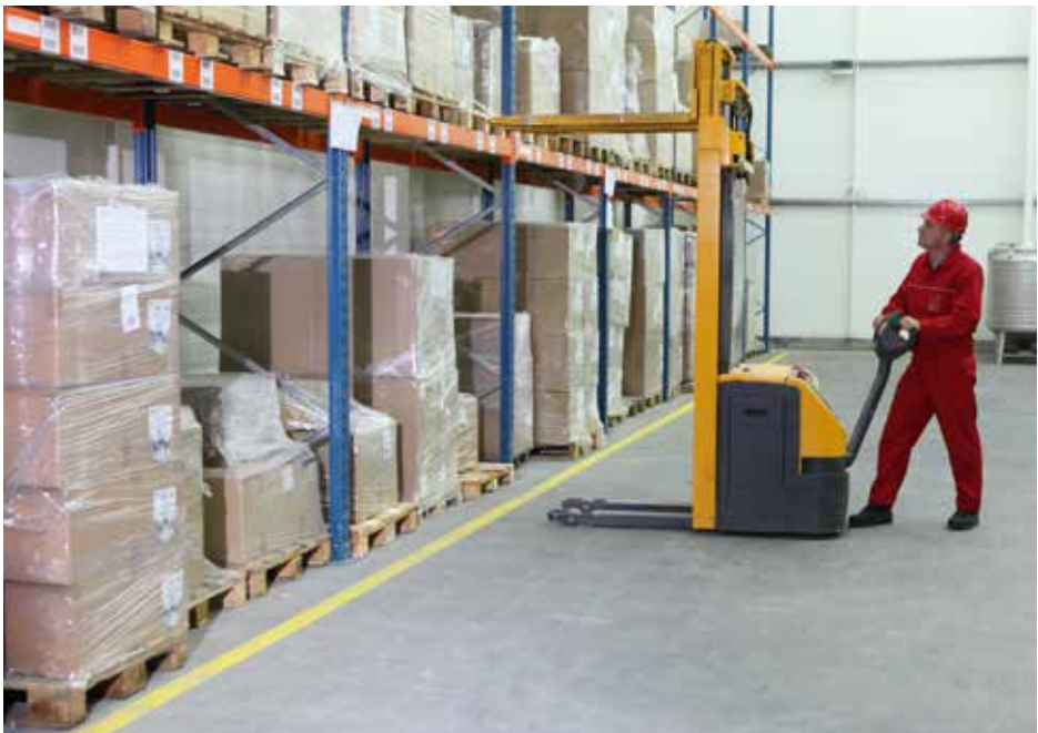
Bild 6-1: Mitgänger-Flurförderzeug mit sicherheitstechnisch und ergonomisch günstig gestaltetem Steuerungshandgriff
