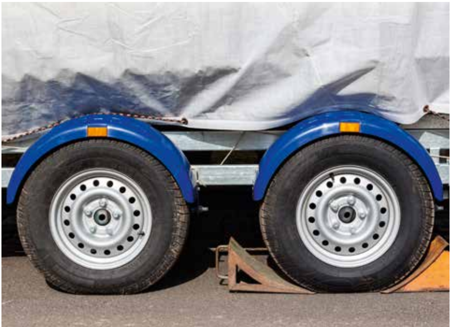
Bild 9-1: Festlegen des Fahrzeuges mit Unterlegkeilen am Rad
