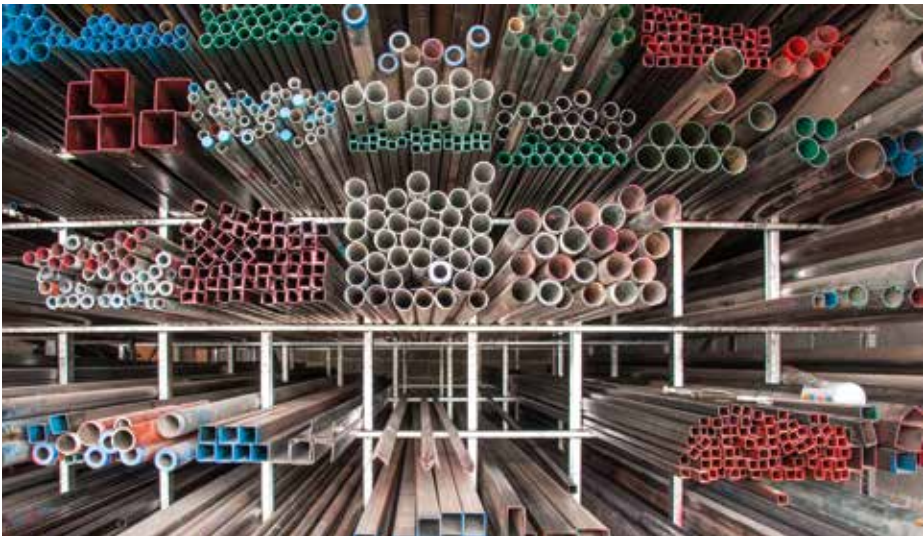
Bild 13-1: Gestapelte Stangen und Rohre, gegen Wegrollen und Herabfallen gesichert
