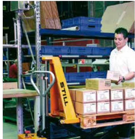
Bild 5-3: Kommissionieren mit höhenverstellbarem Handhubwagen
