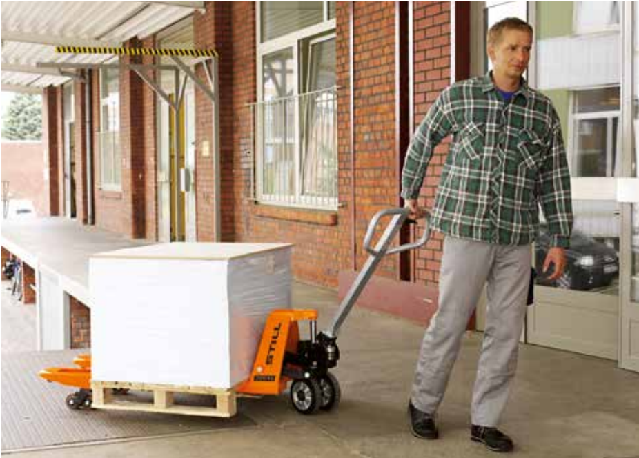
Bild 5-4: Hydraulisch betriebener Handgabelhubwagen mit Bremseinrichtung
