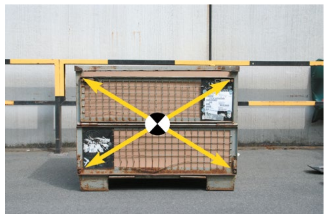
Bild 6-5: Der Schwerpunkt der Last liegt in der Regel auf halber Lasttiefe
