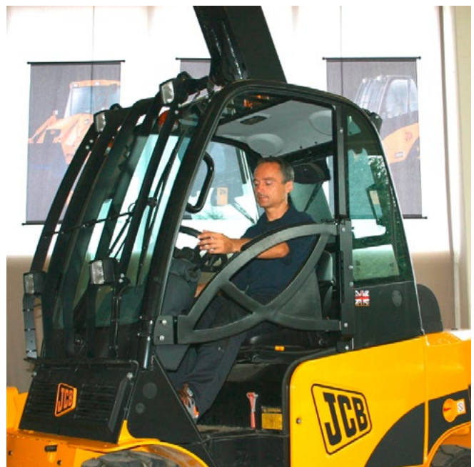
Bild 2-7: Bügeltüren als Rückhalteeinrichtung.
