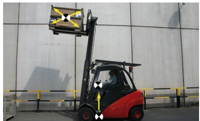
Bild 6-22: Verlagerung des Gesamtschwerpunktes bei angehobener Last
