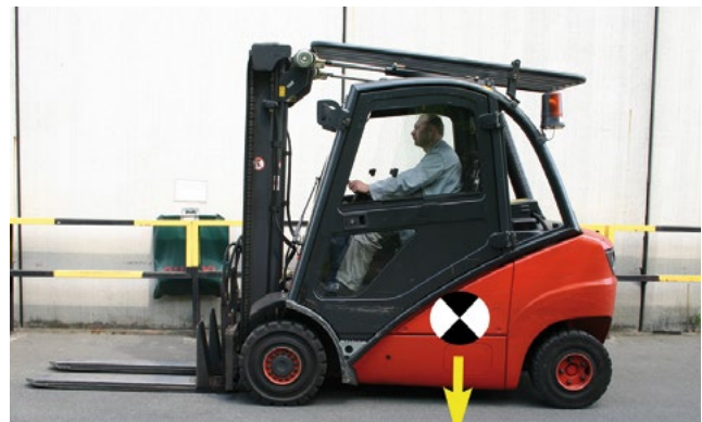
Bild 6-19: Der Schwerpunkt des Gabelstaplers und ...
