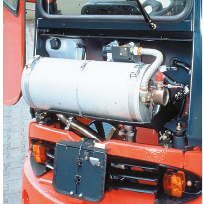
Bild 3-1: Gabelstapler mit Rußfilter und integrierter Regenerations-einrichtung
