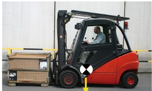
Bild 6-21: ... ergeben den Gesamtschwerpunkt bei abgesenkter Last
