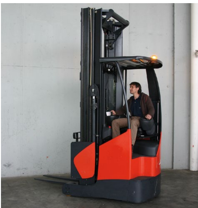
Bild 6-16: Für regelmäßiges Rückwärtsfahren geeigneter Quersitzstapler
