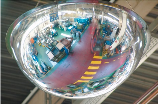
Bild 6-3: Kugelspiegel an unübersichtlicher Stelle
