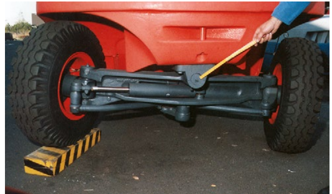
Bild 6-24: Da beim Vierrad-Gabelstapler die Hinterachse als Pendelachse ausgeführt ist, erfolgt nur eine einzige mittige Unterstützung der Last, nämlich im Lager der Pendelachse
