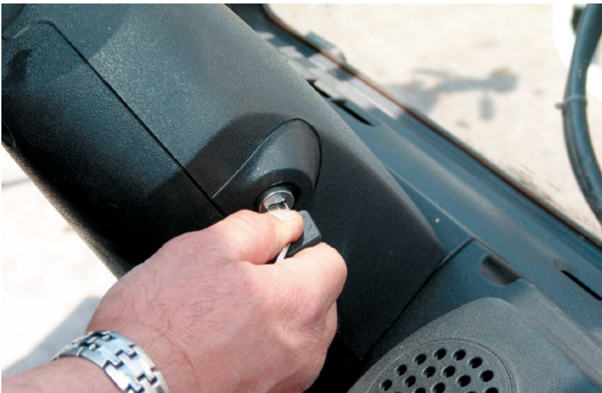
Bild 7-1: Gabelstapler erst verlassen, wenn Antrieb stillgesetzt und Schlüssel abgezogen ist
