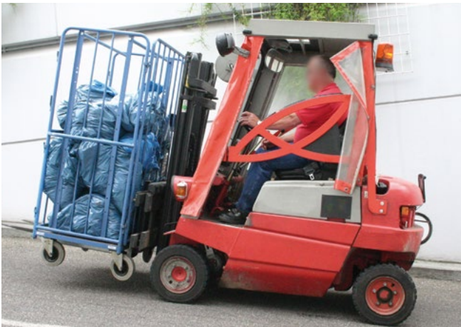
Bild 6-23: Last immer bergseitig führen
