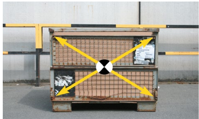
Bild 6-20: ... der Schwerpunkt der Last ...
