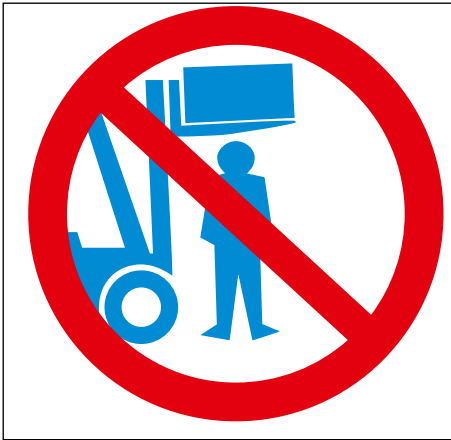
Bild 2-3: Anschlag „Aufenthalt unter der Last verboten“
