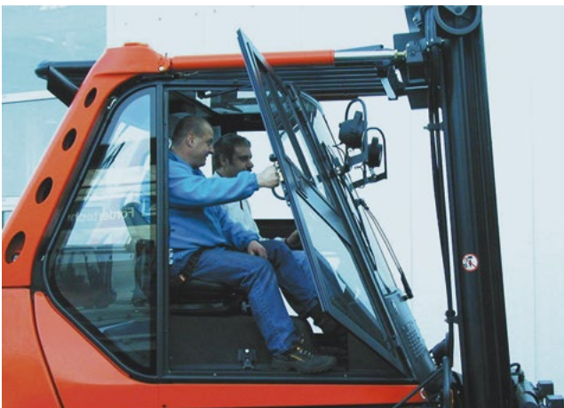
Bild 8-1: Gabelstapler mit Beifahrersitz, Rückhalteeinrichtung und Haltegriff für Beifahrer
