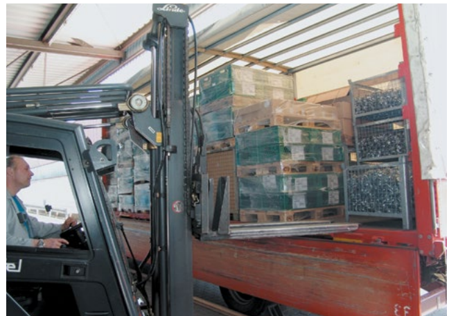
Bild 8-5: Beim Be- und Entladen von Fahrzeugen sind diese immer gegen Wegrollen zu sichern. Das heißt, der Gang ist einzulegen, die Feststellbremse anzuziehen und der Unterlegkeil unterzulegen
