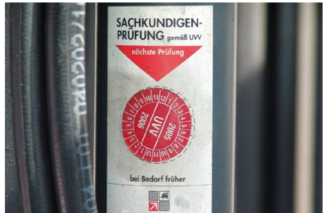
Bild 5-2: Die Prüfplakette erleichtert es dem Fahrer, die Prüfristen zu überwachen
