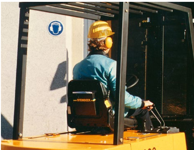
Bild 3-2: Ergonomisch ausgebildeter Fahrersitz. Fahrer trägt im Lärmbereich Gehörschutzkapseln
