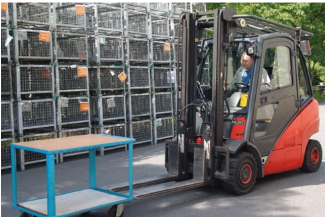
Bild 6-1: Das Verschieben von Gegenständen mit den Gabelzinken ist unzulässig
