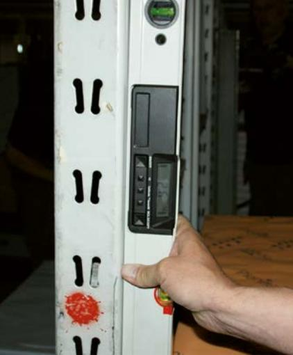
Abb. 10 Messung der Schiefstellung mit digitaler Wasserwaage
