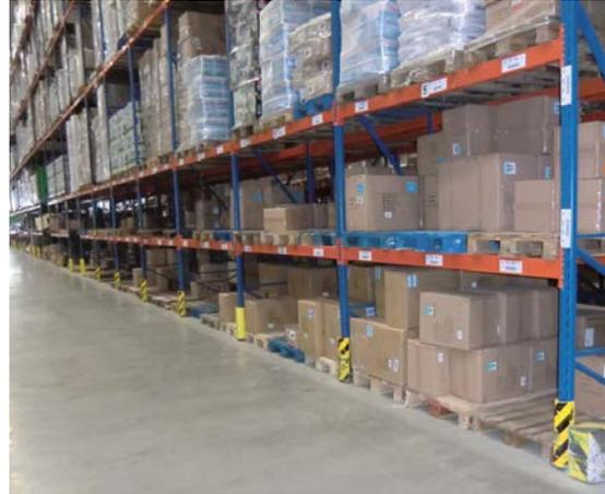
Abb. 19 Stützenschutz an allen Stützen
