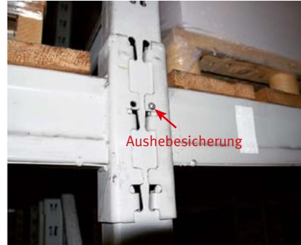
Abb. 13 Fehlende Aushebesicherung
